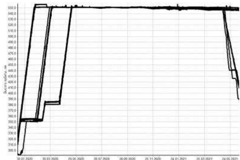
Рис.1 Графики изменения высоты КА из состава группового запуска (57 КА) системы StarLink от 07.01.2020 ( i=53 град, время развертывания в рабочих плоскостях: 1,5 мес+1,5 мес + 1.5 мес.)
