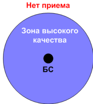
Рис.2 Зона обслуживания БС цифровой сети (например, DMR)
