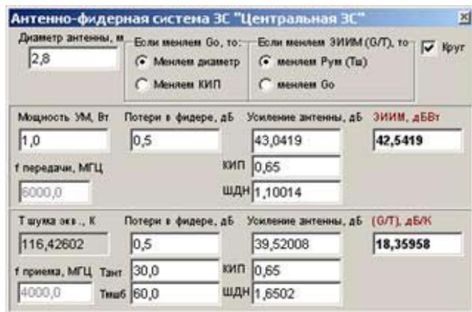
Рис.2 Детализация энергетических характеристик ЗС
